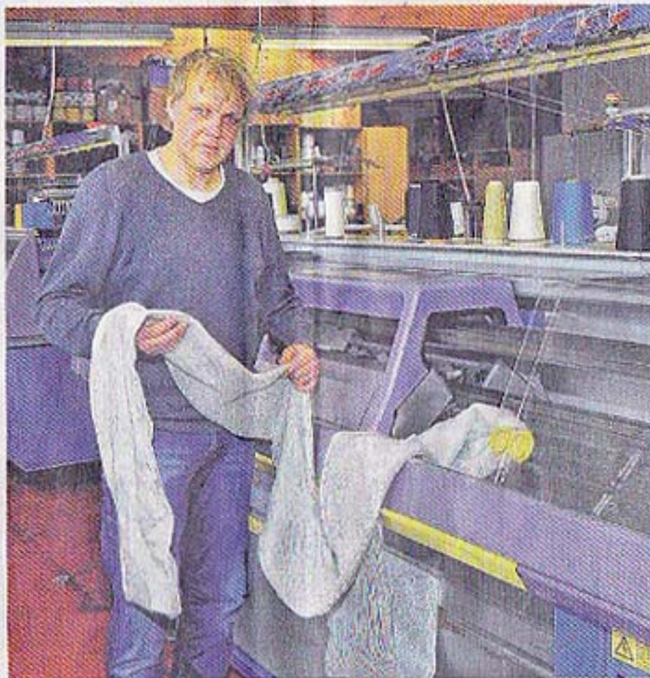
Thorsten Bache von „Bache Innovative“ überprüft an einer Strickmaschine einen Glasfaserschlauch.
